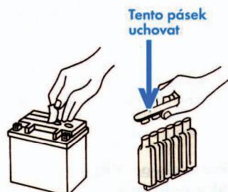
**3** Umístit kontejner elektrolytu utěsněným vrškem článků dolů do plnicích otvorů akumulátoru. Kontejner stlačit dolů, aby se porušilo těsnění. Uvidíte vzduchové bublinky při plnění otvorů akumulátoru. Kontejner elektrolytu nenakláňat. **Varování:** Nesprávná aktivace nebo nadměrné přebíjení (možné při chybě nabíjecího vybavení) může poškodit akumulátor nebo vozidlo únikem kyseliny z ventilačního otvoru.
